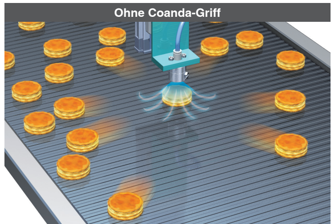
Die Werkstücke können durch den Ausblasimpuls zerstreut werden.
