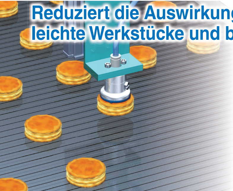
Die Werkstücke können durch den Ausblasimpuls zerstreut werden.
